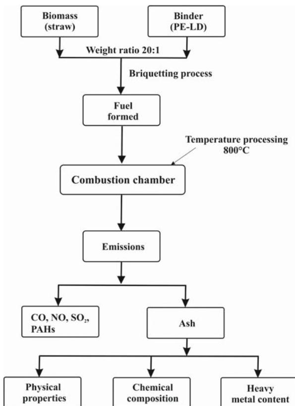
Fig. 2. Diagram of experiment (by M. Czop, M. Kajda-Szcześniak)
